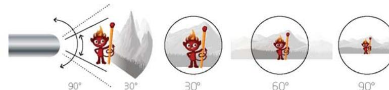
Угол поля обзора: угол отображения поверхности обследуемой области. Чем больше угол, тем шире панорама обзора
